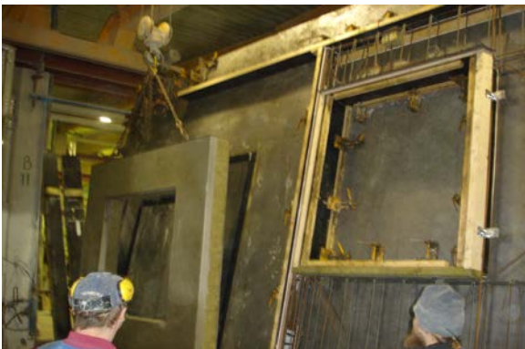
alsecco PreWis 2 : pohjalaastikerros verkkoineen + eristeet muotissa tehtaalla. Toimii vain sementtipohjaisella pohjalaastilla. Elementin nosto valua seuraavana aamuna.
