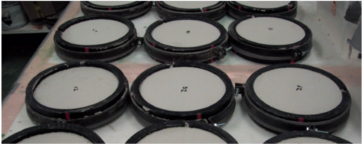
Kuva 2. Koekuppien kansien valmistusta. Muotissa on verkotuslaastia n. 3 mm kerros. Pintalaastin levitystä varten kovettunutta verkotuslaastikerrosta on laskettu 3, 6 ja 9 mm syvyyteen muotin reunasta.
