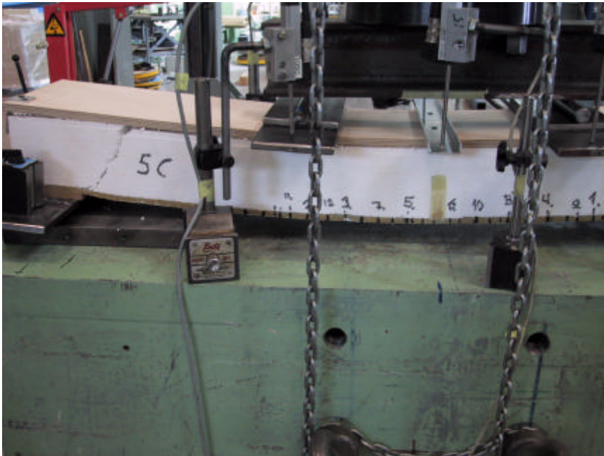
Kuva 7. 300 mm jatkoksella varustetun 5 C-rakenteen leikkausmurtuma. Muissa rakenteissa murtuma tapahtui varauksen alueella verkkojen liukuessa laastin leikkautumisen vuoksi.
