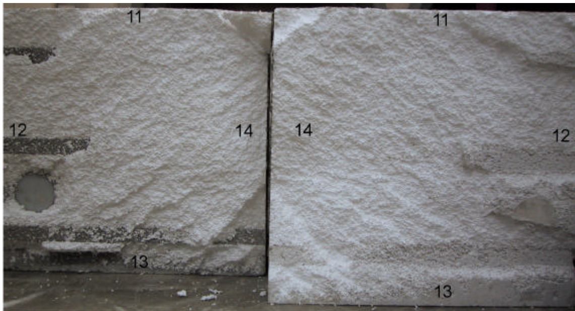
Kuva 6. Elementin K11.2 jännitys-muodonmuutos-kuvaaja sekä murtopinnan yleiskuva. Kuvaan on merkitty siirtymäanturien sijainti. Halkaisijaltaan 90 mm raudituskorokkeen pohjat muodostivat tartunnattoman kohdan, joka pienensi murtokuormaa ja lisäsi koekappaleen epäkeskisyyttä. Vetopulttien epäkeskisyyden aiheuttama reunajännityksen maksimi 13-14 kulmassa oli 4,5 % suurempi kuin koko pinta-alalle (600*600) laskettu vetojännitys.
