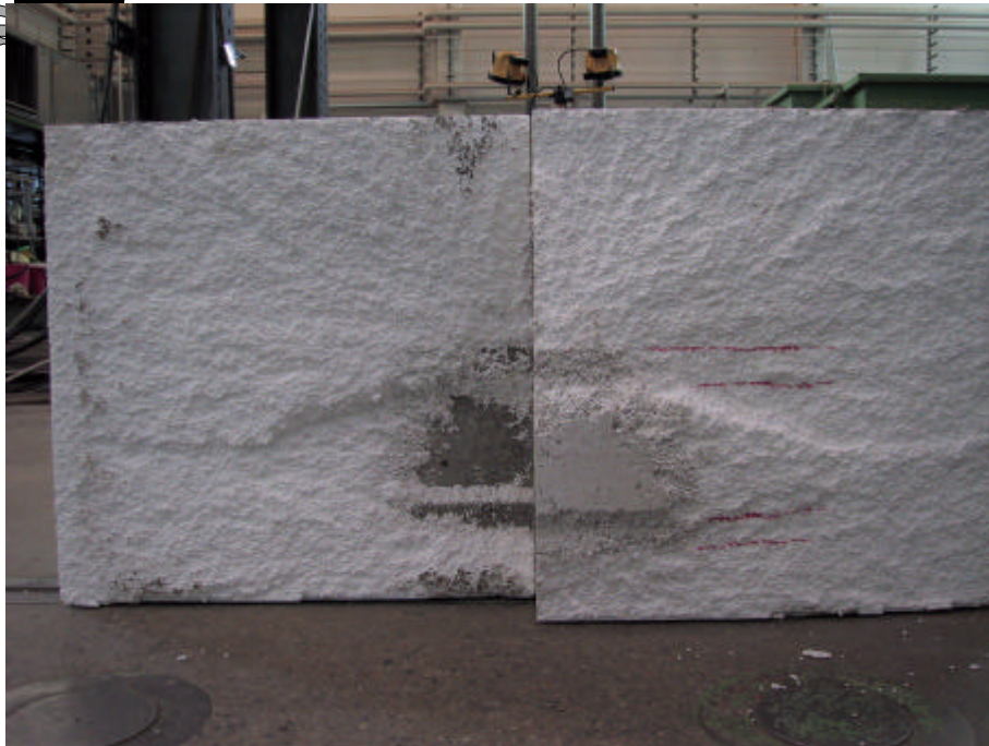
Kuva 3. Koekappaleen K1 murtopinna yleiskuva. Betonipintaa ja uria on väin vähän näkyvissä.
